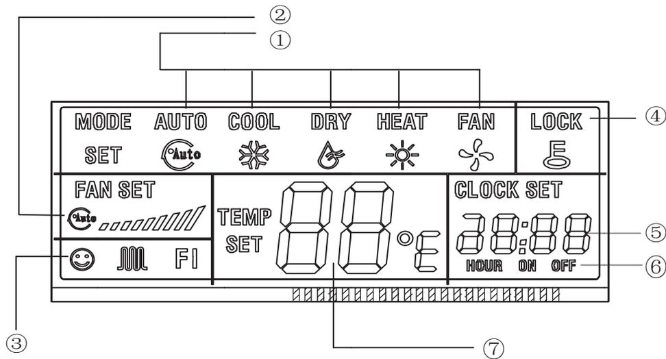
1. Поле дисплея отображающее выборанный режим работы устройства. Изменение режима работы устройства осуществляется с помощью нажатия кнопки **[MODE]** ( режим HEATING не активен для устройств предназначенных только для охлаждения).
