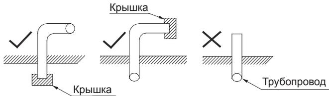
2. При подаче трубы через отверстие в стене обязательно одевайте заглушку на конец трубы.
